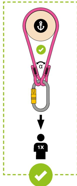
**Note :** *Un seul utilisateur (100 kg max.) / Angle maximal de charge :  $\alpha = 90^\circ$  / La charge maximale susceptible d'être retransmise à la structure est d'environ 8 kN / Force statique : 18 kN*
