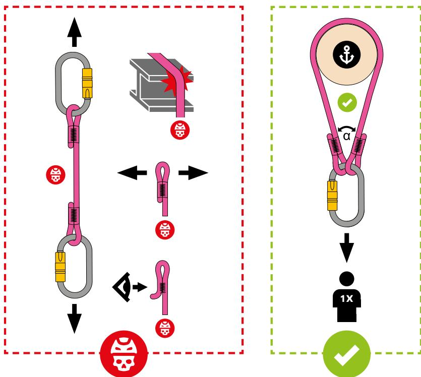
**Nota:** Un solo usuario (100 kg máx.) / Ángulo máximo de carga:  $\alpha = 90^\circ$  / La carga máxima que se puede transmitir a la estructura es de aproximadamente 8 kN / Fuerza estática: 18 kN
