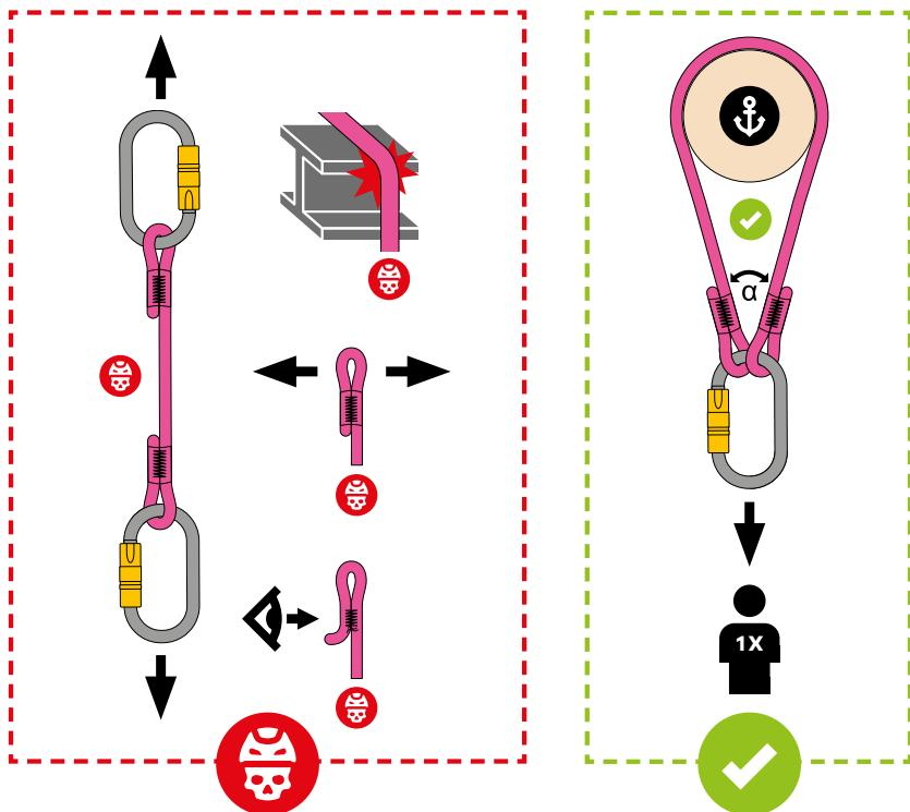
**Note :** Un seul utilisateur (100 kg max.) / Angle maximal de charge :  $\alpha = 90^\circ$  / La charge maximale susceptible d'être retransmise à la structure est d'environ 8 kN / Force statique : 18 kN
